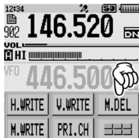
Частота будет удалена из канала памяти пропускаемых частот.
