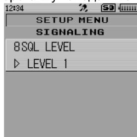
**Примечания** • Уровень порога шумоподавителя может быть отрегулирован в пределах от 0 до 15.
