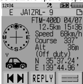
Пример индикации на дисплее при приеме сигнала APRS
