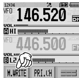
**Совет.** Выполните предлагаемую ниже процедуру для сохранения частот, нежелательных для сканирования, в «каналах памяти пропускаемых частот».
