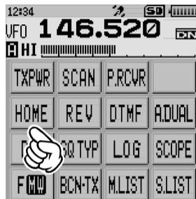
Будет установлен домашний канал для текущего частотного диапазона.
